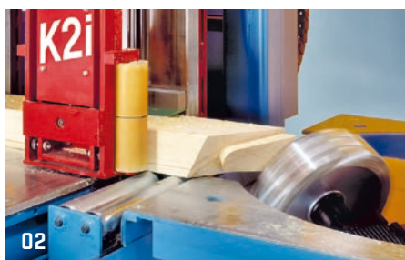
02 > Stroj nese označení K2i-1250 a je schopen s milimetrovou přesností a bez nutnosti měření a rýsování opracovávat materiál v rámci sériové i kusové výroby
